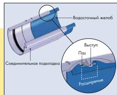
Система выступ-паз интегрирована в полукруглые водосточные желоба RG 75, RG 100, RG 125 и RG 150
