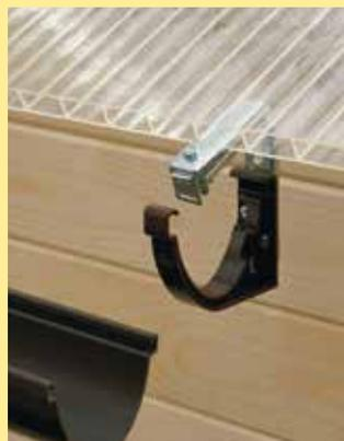
Специально для крыш небольшой площади, которые часто покрыты гофрированным листом или панелями, Marley разработала крепежный зажим. С его помощью можно монтировать прямоугольные, дуплексные желоба и желоба RG 75 и RG 100 непосредственно на гофрированный лист или панели толщиной от 3 до 16 мм. В случае двойных полых панелей зажим крепится в полости и не видим.
